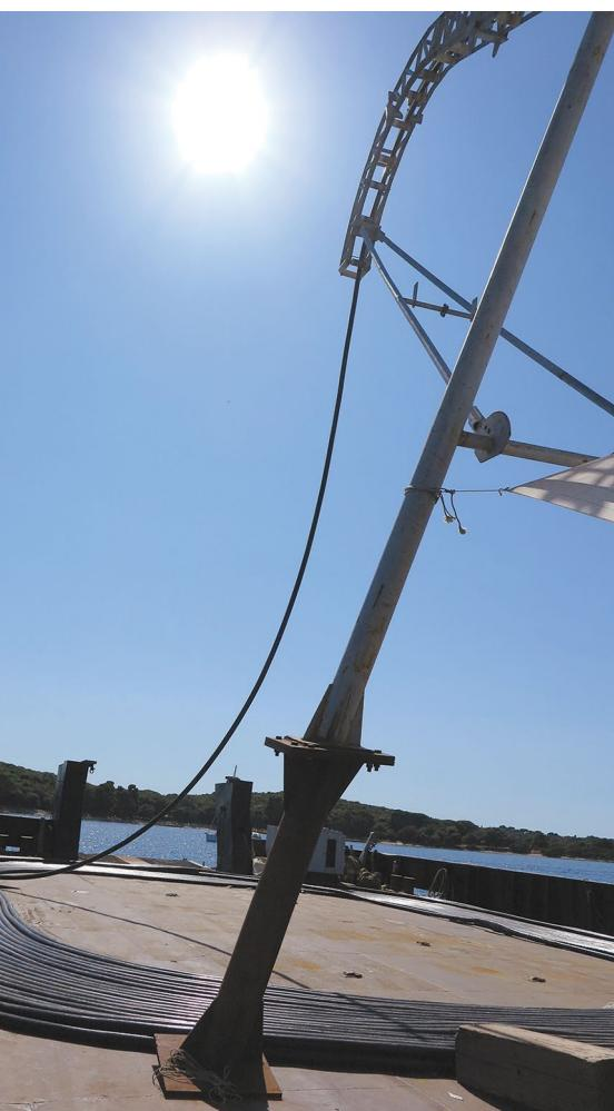
↑ Na brodu je najvažniji dio opreme 14-metarska hidraulična vodilica, tzv. žirafa, čiji su izgled i funkciju osmislili HEP-ovi radnici
