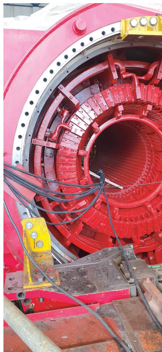
↑ Stator generatora tokom ispitivanja
